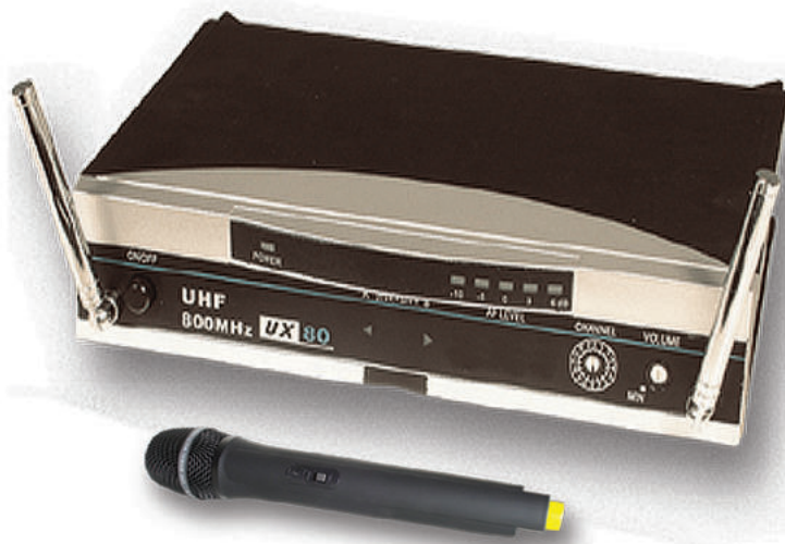
Microfone Sem Fio Profissional Modelo UX 80 B (Cód. 10503) UHF 16 CANAIS
